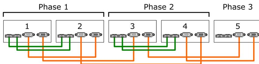
Figure 33 : Câblage de communication de cinq onduleurs dans un système triphasé (2 + 2 + 1)
