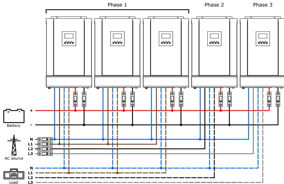
Figure 30 : Câblage de cinq onduleurs dans un système triphasé (3 + 1 + 1)
