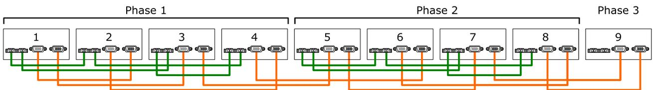
Figure 52 : Câblage de communication de neuf onduleurs dans un système triphasé (4 + 4 + 1)
