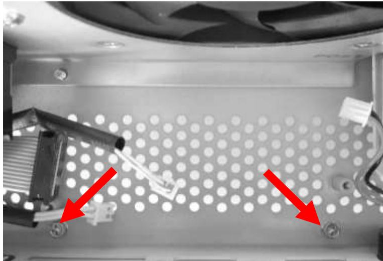
Figure 6 : Retirez les vis du couvercle du connecteur parallèle.
