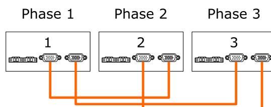
Figure 27 : Câblage de communication de trois onduleurs dans un système triphasé
