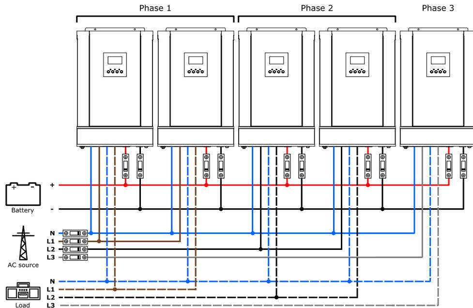
Figure 32 : Câblage de cinq onduleurs dans un système triphasé (2 + 2 + 1)
