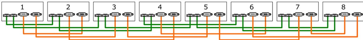
*Figure 24 : Câblage de communication de huit onduleurs parallèles sur monophasé.*
