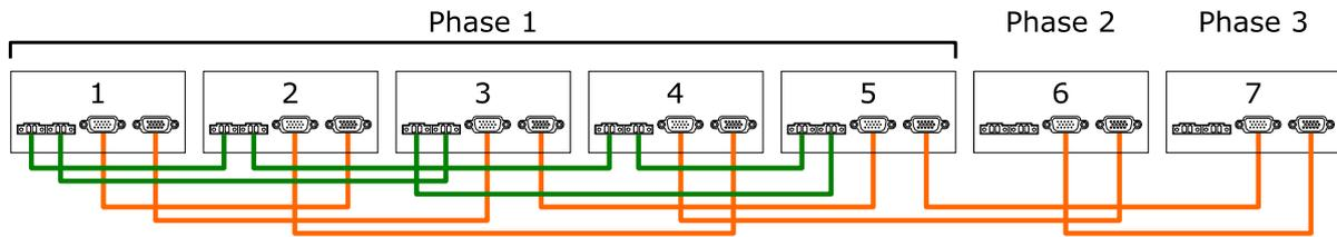
Figure 44 : Câblage de communication de sept onduleurs dans un système triphasé (5 + 1 + 1)
