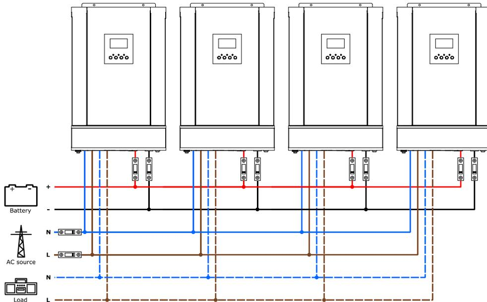
Figure 18 : Câblage de quatre onduleurs parallèles sur monophasé.
