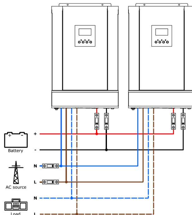
Figure 14 : Câblage de deux onduleurs parallèles sur monophasé.
