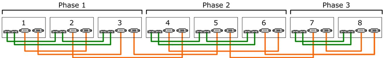
Figure 47 : Câblage de communication de huit onduleurs dans un système triphasé (3 + 3 + 2)
