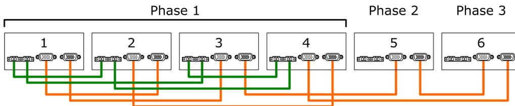
Figure 37 : Câblage de communication de six onduleurs dans un système triphasé (4 + 1 + 1)
