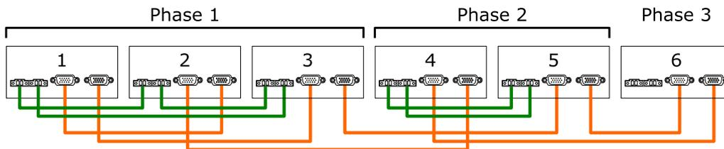
Figure 35 : Câblage de communication de six onduleurs dans un système triphasé (3 + 2 + 1)
