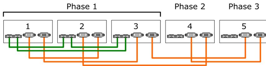
Figure 31 : Câblage de communication de cinq onduleurs dans un système triphasé (3 + 1 + 1)
