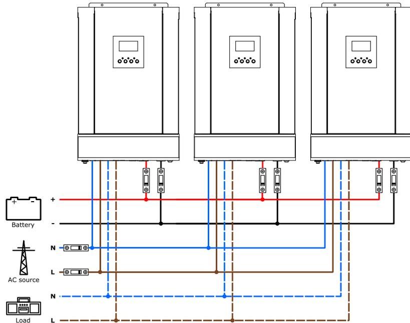
Figure 16 : Câblage de trois onduleurs parallèles sur monophasé.
