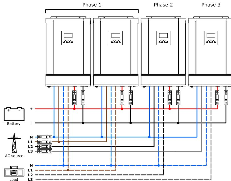
Figure 28 : Câblage de quatre onduleurs dans un système triphasé (2 + 1 + 1)
