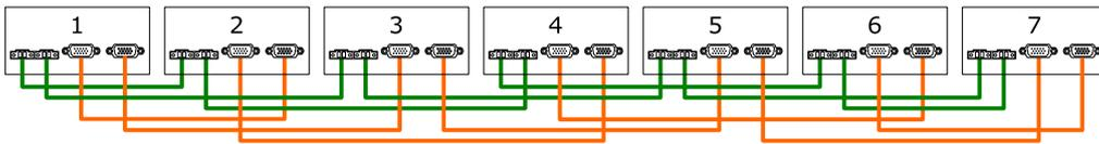
*Figure 23 : Câblage de communication de sept onduleurs parallèles sur monophasé.*
