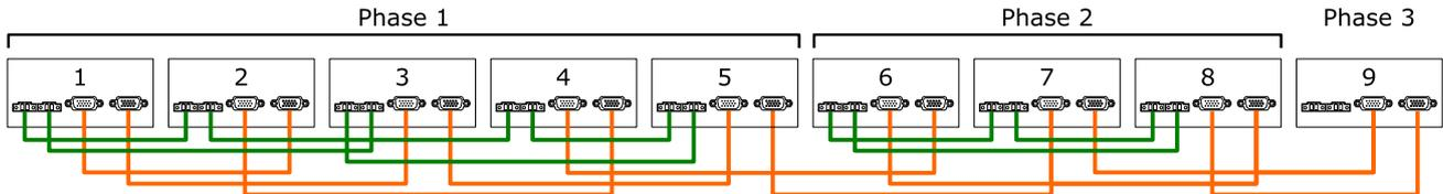
Figure 54 : Câblage de communication de neuf onduleurs dans un système triphasé (5 + 3 + 1)
