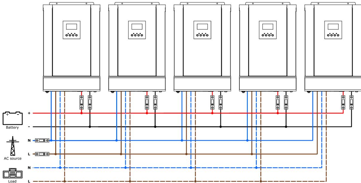
Figure 20 : Câblage de cinq onduleurs parallèles sur monophasé.
