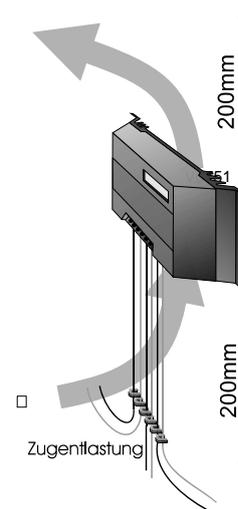
Le régulateur est adapté à un montage mural vertical. C'est la seule manière de garantir un refroidissement suffisant par l'air montant (effet de cheminée) et un fonctionnement correct de l'administrateur de système.
