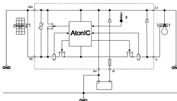
Les passages suivants décrivent uniquement les possibilités techniques de mise à la terre. Le but est le maintien des fonctions du régulateur. L'installateur doit considérer et respecter les consignes nationales du lieu d'installation. La perte du statut de sécurité basse tension causée par la mise à la terre doit être compensée par les mesures d'isolation adéquates des pièces actives (protection contre un contact direct).
