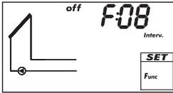
Schaltet die Solarkreispumpe in Intervallen ein, damit die tatsächliche Kollektortemperatur gemessen wird. Die Wartezeit zwischen 2 Einschaltvorgängen und die Dauer der Einschaltzeiten sind einstellbar. Anwendungsfälle:
