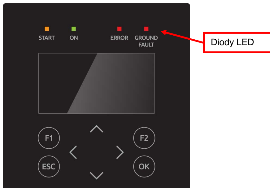
Ilustracja 20: Panel obsługi z diodami LED stanu, wyświetlaczem i przyciskami
