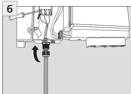
Le câble AC doit être hors tension
