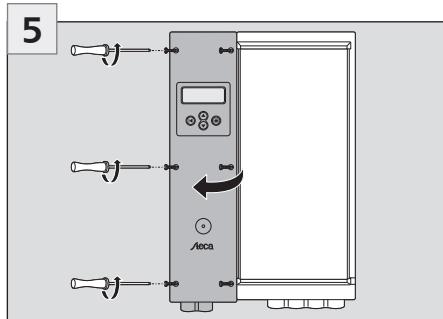
Le câble AC doit être hors tension
